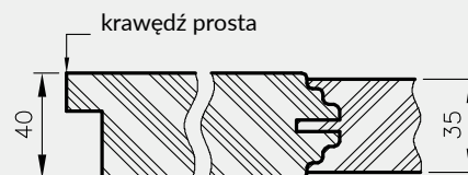
Przekrój poziomy drzwi Scala, Berge
