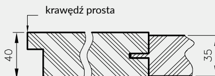
Przekrój poziomy drzwi Scala, Berge
