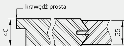
Przekrój poziomy drzwi Elsa
